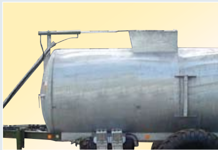
Hydraulischer Schubdeckel, 700 mm x 700 mm Öffnung.
