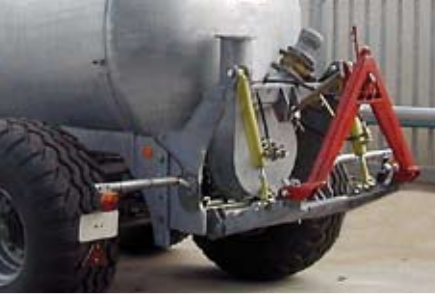
Dreipunkthydraulik für Schleppschuhverteiler, Güllegrubber etc.
