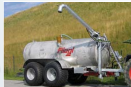
Saugrüssel für Obenabsaugung.
