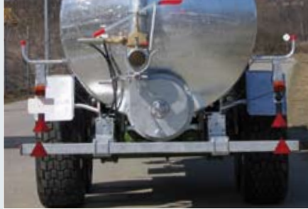
40 km/h Ausführung mit Kotflügel und Unterfahrschutz.
