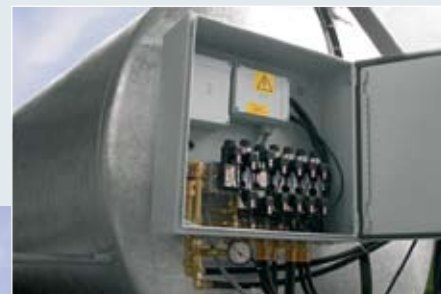
Elektromagnetischer Steuerblock zur einfachen Bedienung der Hydraulikfunktionen.
