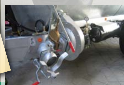
Hydraulisch angetriebener Turbobefüller (Option).
