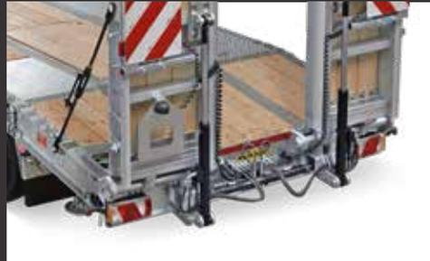
1-teilige hydraulische Rampen mit hydraulischer Seitenverschiebung
