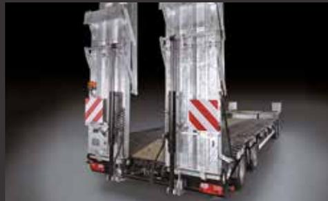
2-teilige hydraulische Rampen mit hydraulischer Seitenverschiebung
