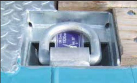
Zusätzlicher im Brückenboden versenkter Zurrpunkt
