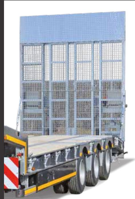
Stahlüberfahrwand über die gesamte Breite mit Gitterrostbelag
